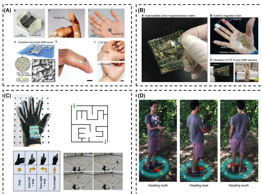
图 7. 柔性磁传感器用于制造磁敏电子皮肤。(A) 3D 打印制造的可贴附磁敏电子皮肤 [6, 26] ；(B) 通过微纳制造构建的单片丙烯酸晶圆电子皮肤用于位置感知 [85] ；(C) 自供电电子皮肤通过人机交互实现运动感知 [12] ；(D) 磁敏电子皮肤感知地磁场实现定位巡航 [29] 。
