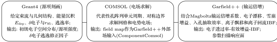
图 2 DG-THGEM 探测器仿真流程图
