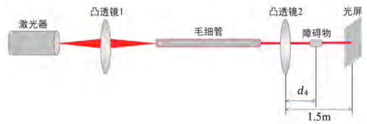
图 11 Bessel 光束自修复特性验证实验光路示意图
