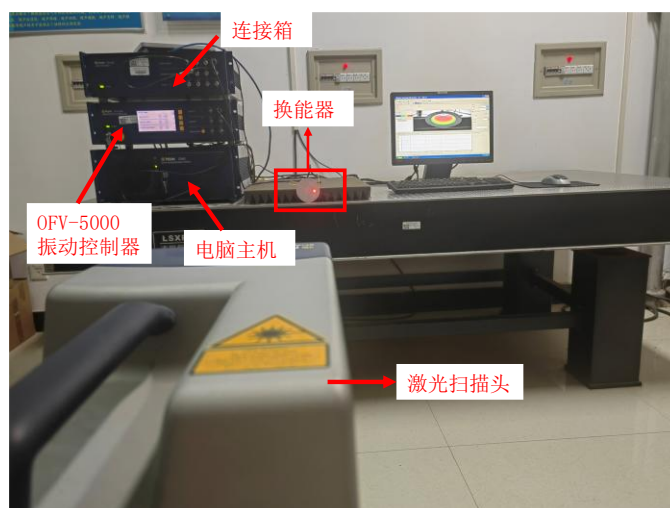
图7 双叠片换能器的激光测振实验
