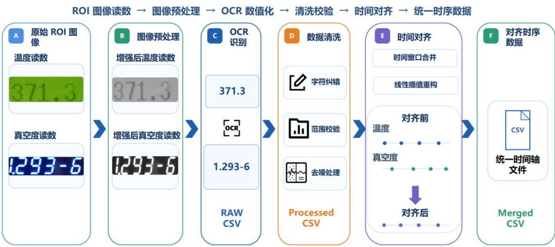
图 4 温度与真空度数据清洗与对齐流程图
