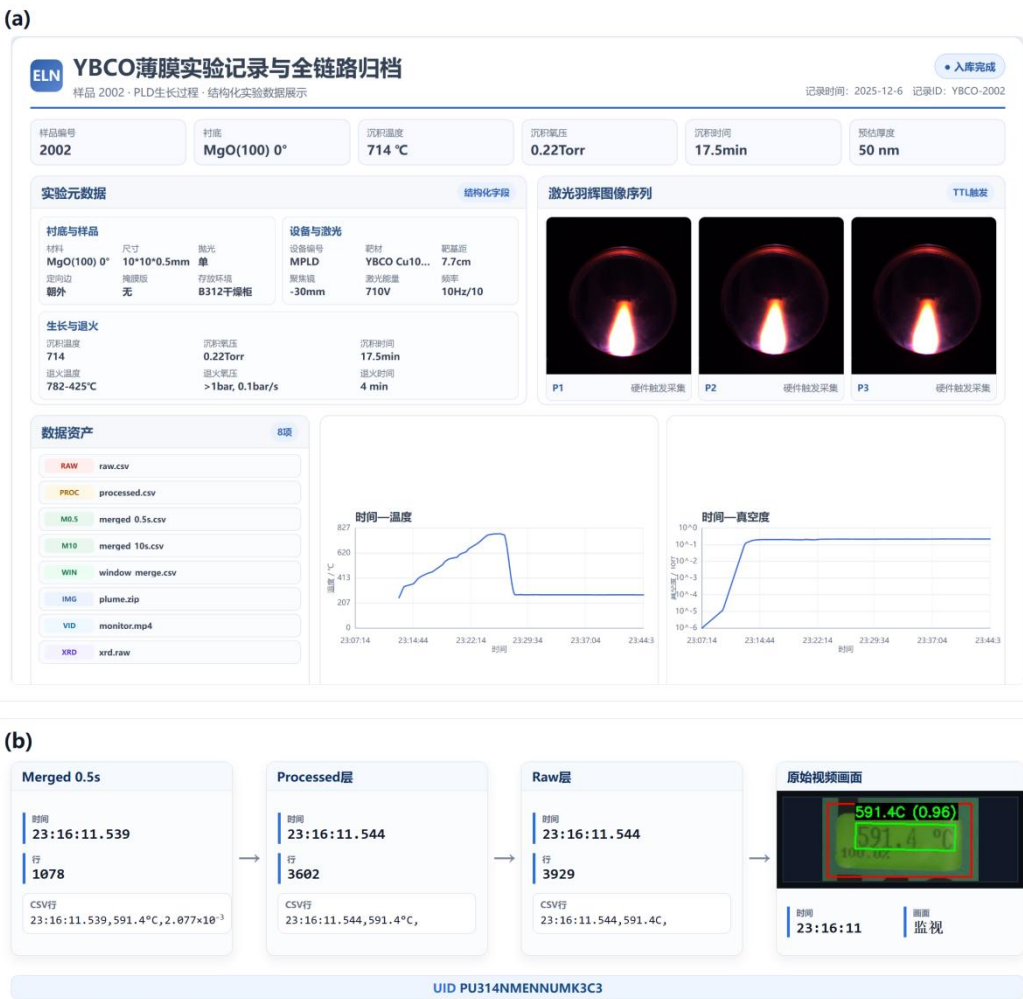
图 11 YBCO 薄膜实验数据的 ELN 结构化归档与完整追溯案例。(a) 实验元数据、羽辉图像、过程曲线、监控视频及 XRD 文件的统一入库；(b) 从 Merged 层经 Processed 层、Raw 层回溯至原始视频画面的数据追溯链。
