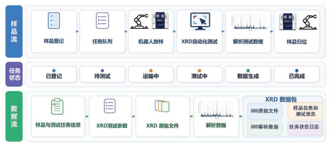
图 3 机器人辅助的薄膜 XRD 自动化测试与数据关联流程图
