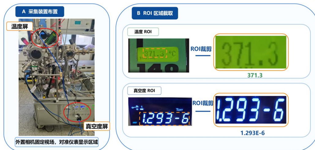
图 2 温度/真空度视觉采集装置与 ROI 区域示意图
