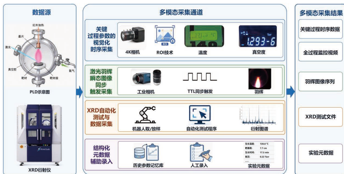
图 1 YBCO 薄膜生长多模态数据采集架构
