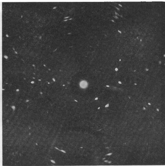
圖 8. 鋁單晶, 630°C 高速斷裂伸拉, 接近斷裂部位
