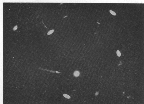
圖 21. 鋁單晶 [表 1 程序 5] 在 550°C 熟煉 10 分鐘的勞厄圖
