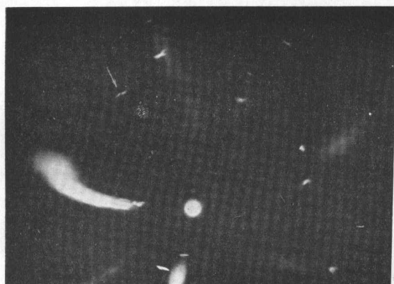
圖 20. 鋁單晶 [表 1 程序 4] 在 500°C 熟煉 180 分鐘的勞厄圖
