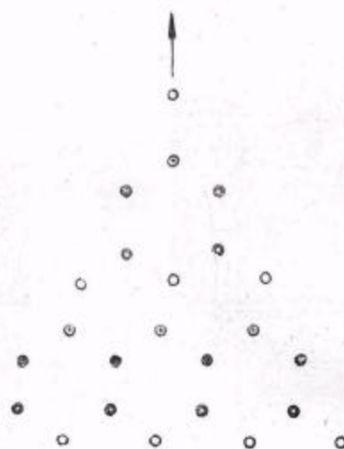
图 VI. (b) 平行于 122 的兩相鄰分子层, 上层分子以白 圈黑点和黑圈白点表示出来, 而下层分子則以黑 点与白圈表示之。
