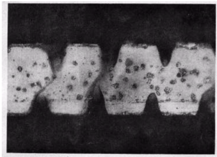
图 15 Fe-Cu 混合鬚的表面結構 250 ×
