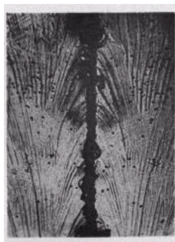
图 9 劈裂面上触斑的对应 \times 86
