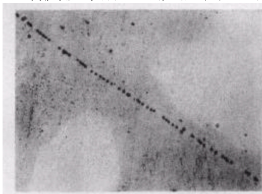
图 11 对称倾斜小角晶界 \times 201
