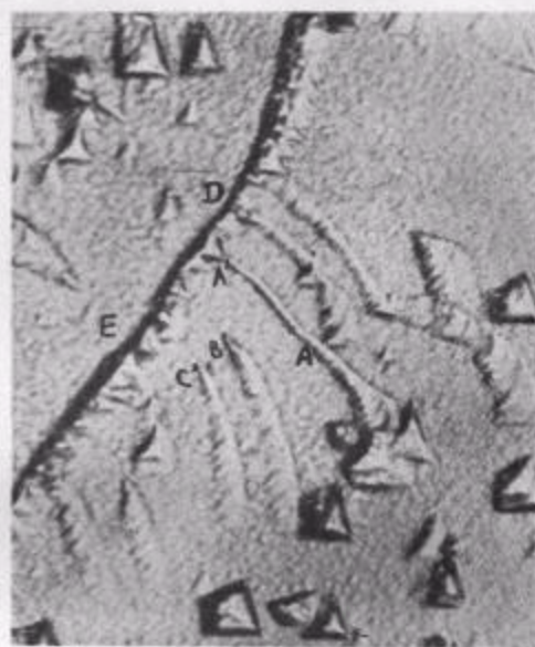
图 15 (b) 继续浸蚀 50 秒后图(a)中蚀象的发展 浸蚀时间 190 秒, 透视深度 10.9 微米 \times 1200
