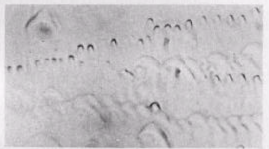
图 10 {110} 面上的浸蚀斑,抛光前的浸蚀斑没有完全抛去,留下了半月形的痕迹 \times 1500
