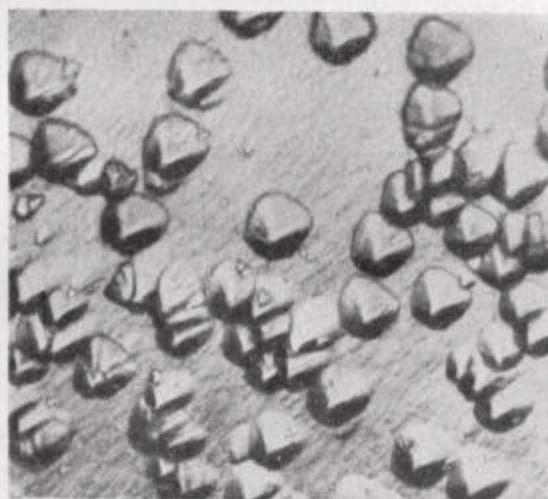
图4 \{100\} 面上金字塔形浸蝕斑 \times 350
