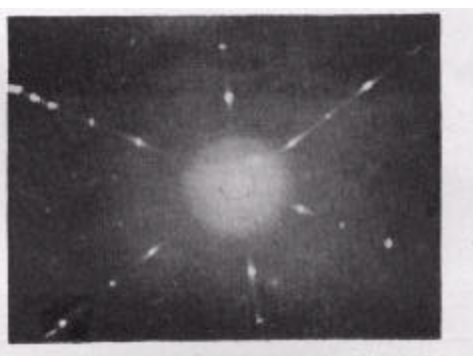
图 6 A-17 晶体的平板劳埃照片。Fe 靶, 40 千伏, 10 毫安, 12 小时。 c 軸平行于入射綫。样品到底片距离 6.5 厘米
