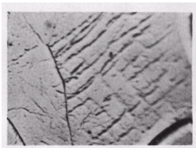
图1 Mo-Ti 合金变形后的多边形組織 变形溫度 1150°C; \epsilon\% = 9\%
