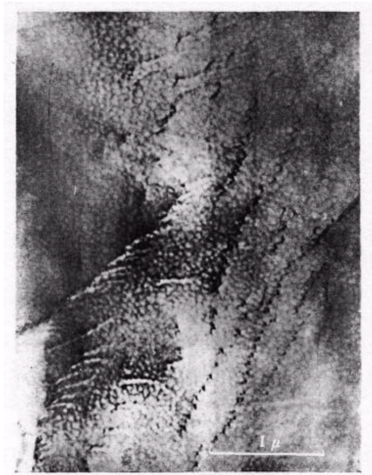
图6 Al-6.7%Mg 合金倾斜晶界处刃型位错列,左边的两列向左方集体运动,产生多边化亚晶界滑移
