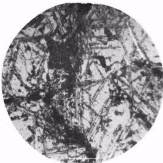
照片 8 热压 Mn-Zn 铁氧化物有裂纹时严重氧化的情况
