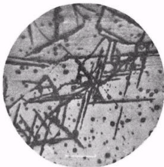
照片 9 热压 Mn-Zn 铁氧体在空气中热处理后的氧化情况
