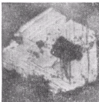
(i) \text{Mg}_3\text{N}_2 + \text{LiH} 触媒, \{111\} ( \times 180 )
