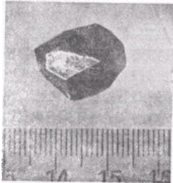
图 2 掺钢的铋钙钒单晶 钢含量每分子 0.139, 4\pi M = 350 高斯, 50 立方厘米坩埚生长(编号 BIn-2)。图内刻度为厘米
