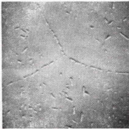
图 1 Fe-Si-Al 合金铸态扫描电子显微镜照片 500×
