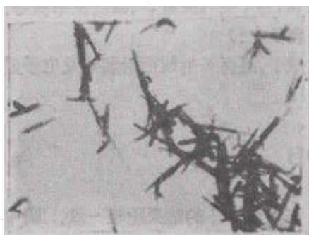
图 2 具有孪晶的 \alpha\text{-FeOOH} 子晶的电子显微镜照片 ( \times 30,000 )
