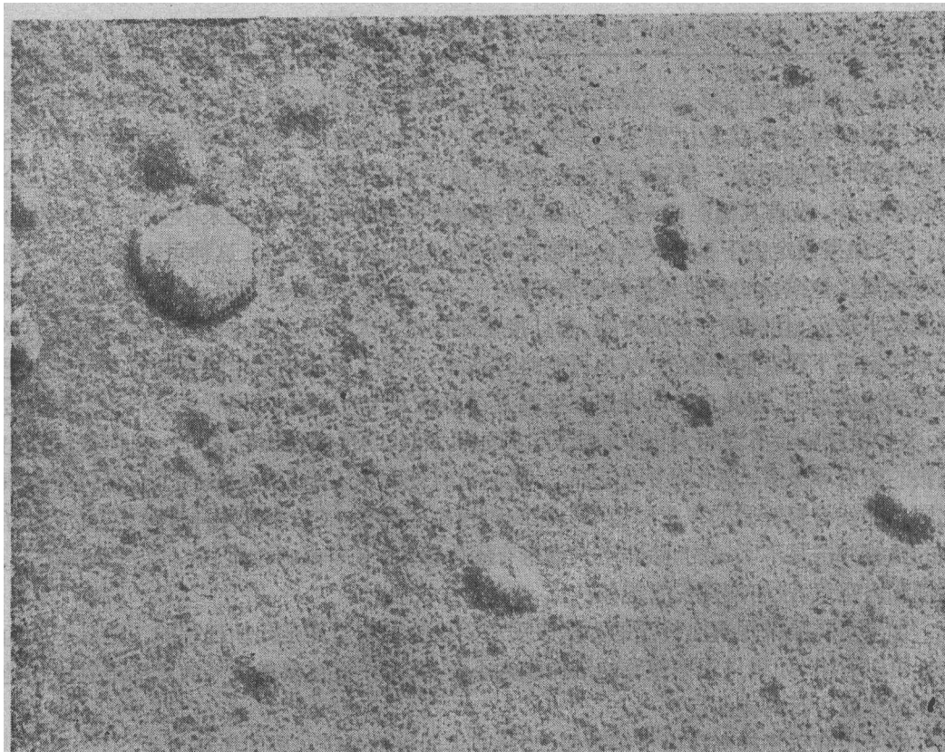
图1 银氧铯阴极表面覆型放大60000倍;阴极积分灵敏度: 21\mu\text{A}/\text{lm}
