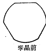
图 8 孪晶前后 InSb 单晶体的横截面形状
