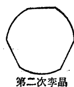
图 8 孪晶前后 InSb 单晶体的横截面形状
