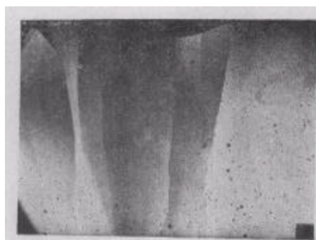
图 4 合成云母于正交偏光下的光学照片 显示出结构堆垛错排的区域
