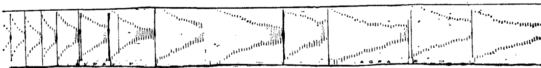
(c) 在 2.5℃ 实验时进行照相所得的部分振幅衰减曲线(第 2—14 点), 由此算出的内耗值见图 3(f)
