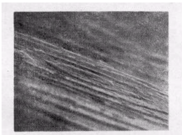
图1 金刚石(100)表面螺位错周围的生长台阶 \times 1660
