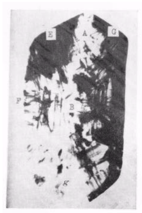
图2 晶体 (01\bar{1}0) 晶面的X射线形貌相 \times 5
