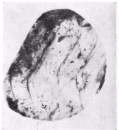
(c) 图 2 中 G 区的 (\bar{1}011) 晶面的 X 射线形貌相 (a) 中的 D 处位错消光 \times 10
