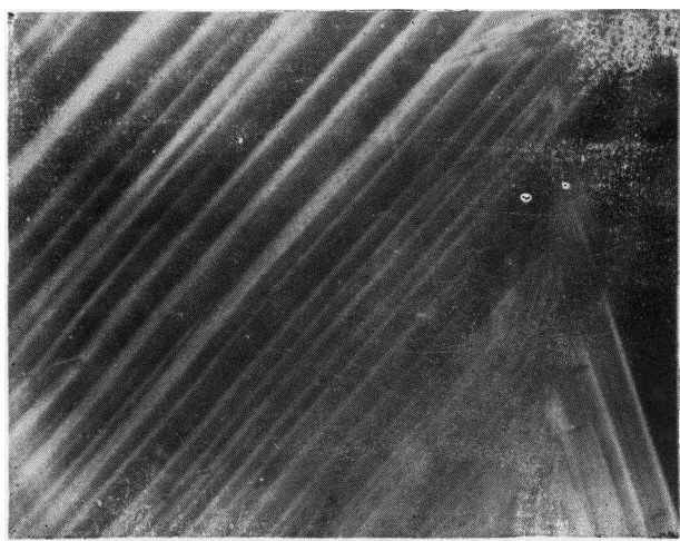
图 3 \text{KIO}_3 单晶的显微照片 (150 \times )
