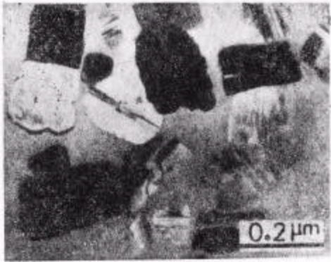
图1 \text{Pd}_{80}\text{Si}_{20} 非晶合金加热至 340^{\circ}\text{C} 析出的 \text{P}_1 亚稳相形貌
