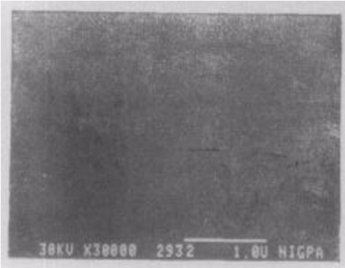
图5 T_s = 300^{\circ}\text{C} , t = 150\text{s} 时,在 Au 衬底表面上仍然没有凝聚团出现
