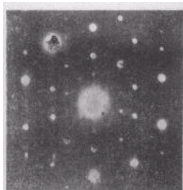
(b) 对应于 (a) 所示区域的电子衍射图样
