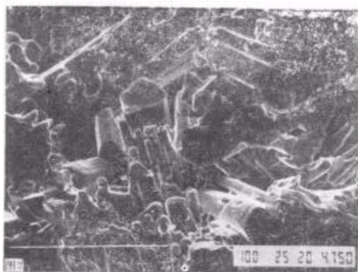
图2 \text{Al}_{65}\text{Cu}_{20}\text{Co}_{15} 合金铸锭断口疏松区的二次电子象 下部横线长度相当 100\ \mu\text{m}
