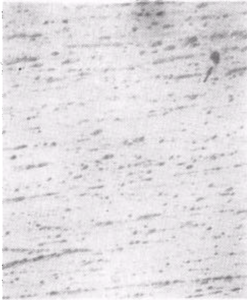
图 3 氮化钛膜面向上弯曲过程临界开裂行为观察
