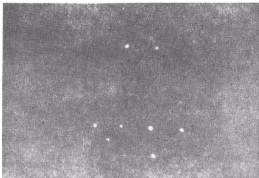
(b) ZnSe (100) 薄膜样品 LEED 图样 E_p = 56\text{eV}
