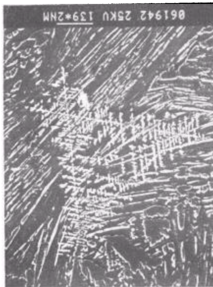
(b) \text{Pd}_3\text{Si} 彼此相连的三角形枝晶
