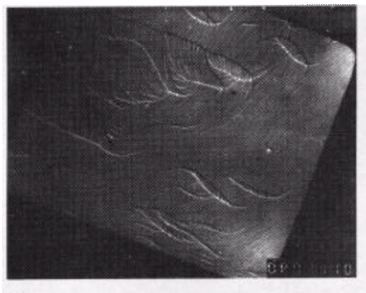
图8 \text{Nd}_{0.21}\text{Fe}_{0.79} 在室温下的磁畴 \times 600
