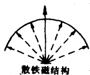
图5 Nd 原子 的散铁磁结构 示意图
