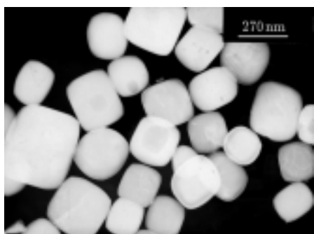
图 2 选用高钡钛摩尔比 ( m(\text{Ba})/m(\text{Ti}) = 2.5 ) 前驱物水热法制得的 \text{BaTiO}_3 晶粒的 TEM 照片( 300^\circ\text{C} , 8 h)
