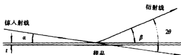
图 2 GIXRD 的原理图
