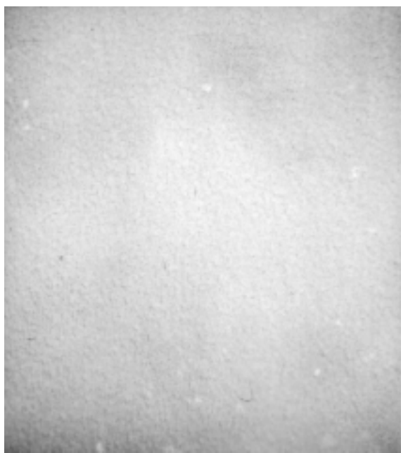
图 3 非晶 \text{SiN}_x 膜的 TEM 照片( \times 30\,000 )
