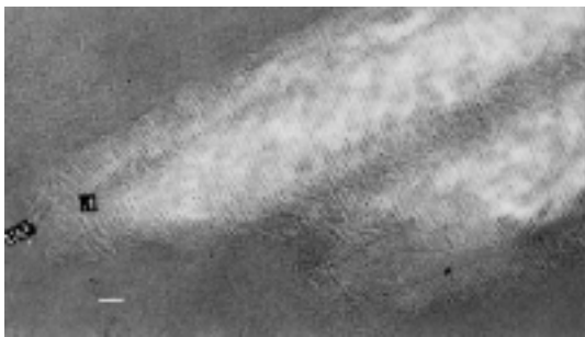
图 3 可能是 \psi=180^\circ 折叠的多层石墨片弯曲物
