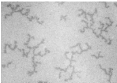
图 1 硅油表面分枝状银原子凝聚体的形貌图 沉积速率 f = 0.20\text{ nm/s} , 凝聚时间 t = 18\text{ h} , 照片面积为 70\text{ }\mu\text{m} \times 50\text{ }\mu\text{m}
