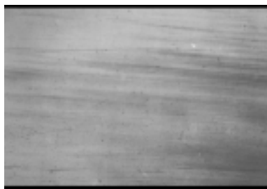
图 4 4 # 样品加电压 V_t=1500 V, 加电压后 26 min 时阴极附近的彩色条纹照片(200 \times )
