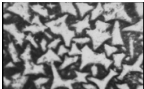
图 6 晶体阳极端面显微形貌象(300×)
