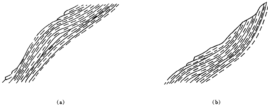
图1 岩板顺层斜坡的变形弯曲 (a)为向上弯曲;(b)为向下弯曲
