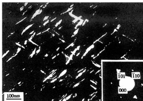
图3 室温注氢的 Fe-1 wt% Ni 在 670 K 电子辐照至 14 dpa 时的辐照损伤组织结构的暗场象
