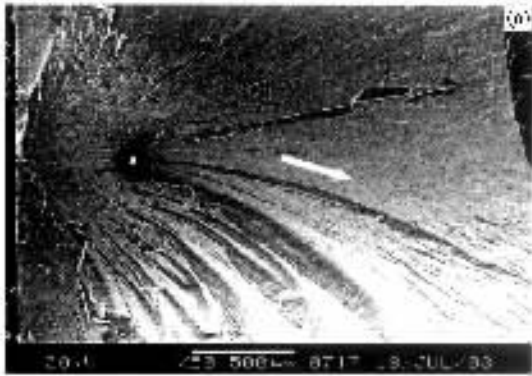
图 7 \text{Ti}_{40}\text{Zr}_{40}\text{Ni}_{20} 准晶室温压缩断口的 SEM 形貌 (a) 河流花样(箭头所指为裂纹扩展方向), (b) 解理台阶及刻面
