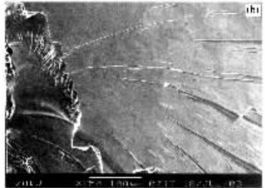
图 7 \text{Ti}_{40}\text{Zr}_{40}\text{Ni}_{20} 准晶室温压缩断口的 SEM 形貌 (a) 河流花样(箭头所指为裂纹扩展方向), (b) 解理台阶及刻面
