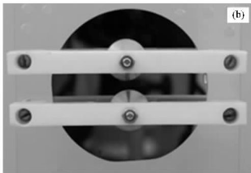
图 2 电极系统结构示意图及实物照片 (a)平面电极系统结构示意图 (b)平面电极系统照片
