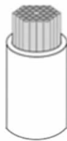
图 1 管棒堆积法制作的 PCF 预制棒
