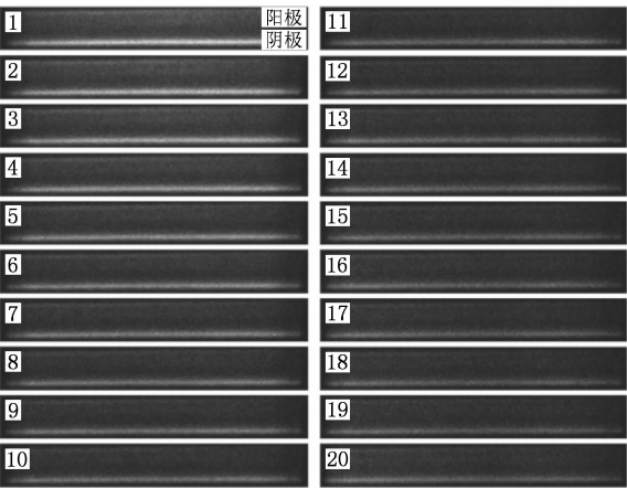
图 6 气隙在第二、三放电电流脉冲之间时 ICCD 短时连续曝光放电图像
