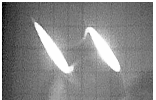
图 11 系统电路实验得到的奇怪吸引子相图
