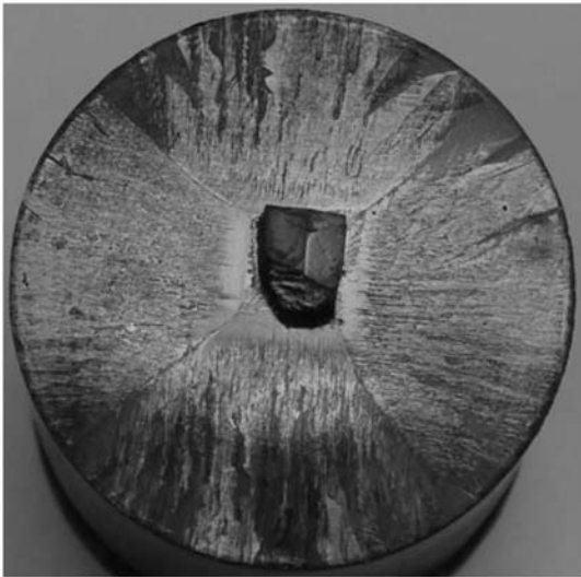
图 4 熔渗生长单畴 GdBCO 超导块材的宏观形貌
