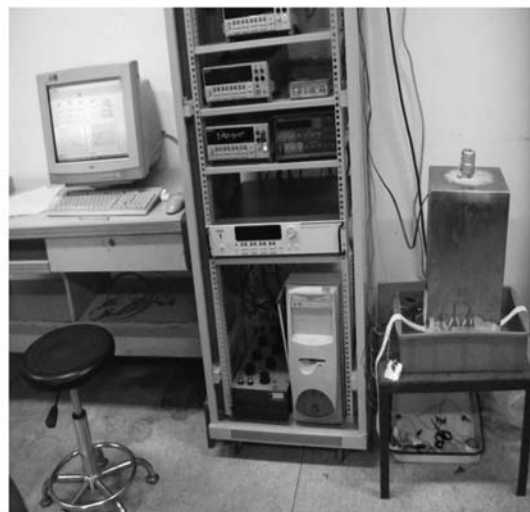
图 6 冷能发电装置实物图
