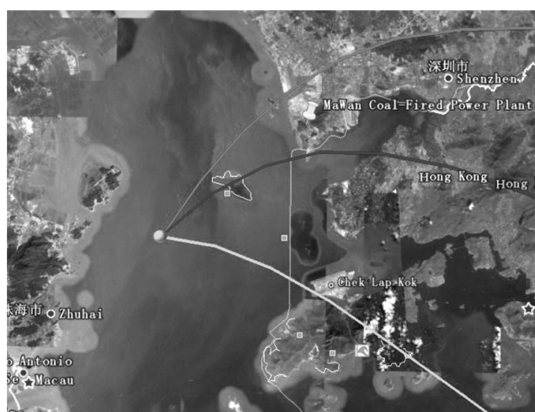
图 9 利用后向轨迹模型计算的 2008 年 12 月 10 日的气流后向轨迹 (从上到下的三条线分别代表 500 m, 1000 m 和 1500 m 三个高度的气流轨迹)
